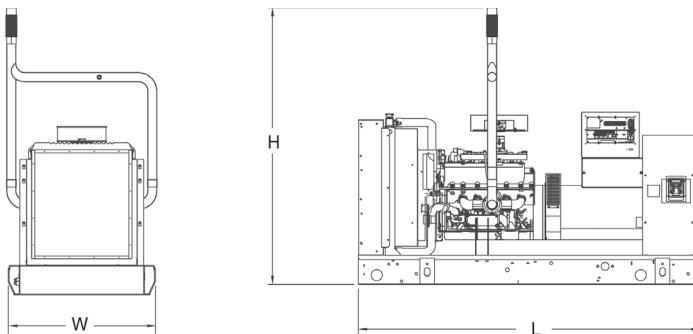
**ОТКРЫТАЯ УСТАНОВКА (включает гибкую выхлопную трубу)**
